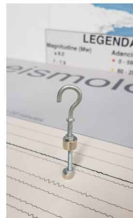
10. Distanțier între magneți M4 face trecerea între bobina și atenuator 1 bucată
